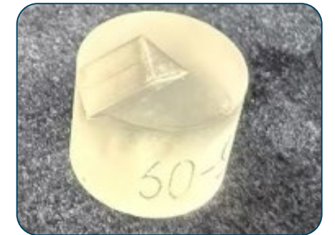
Abb. 3: mittels UKP gefertigter Prismenhalter
