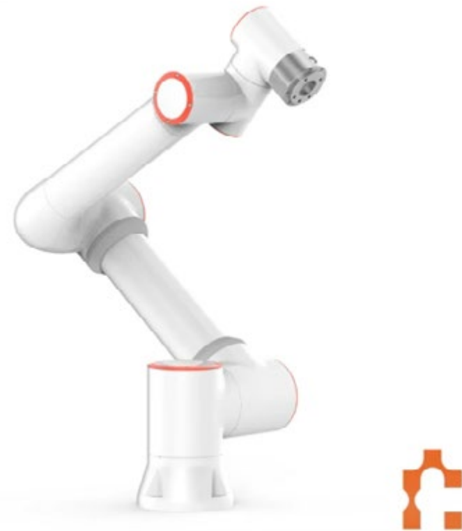
Abb. 7: Vorführansicht des 6-achsigen kollaborativen Roboterarms Fairino FR5 Cobot von Inlux Robotics (Quelle: inluxrobotics.de/products/fairino-fr5-cobot ).
