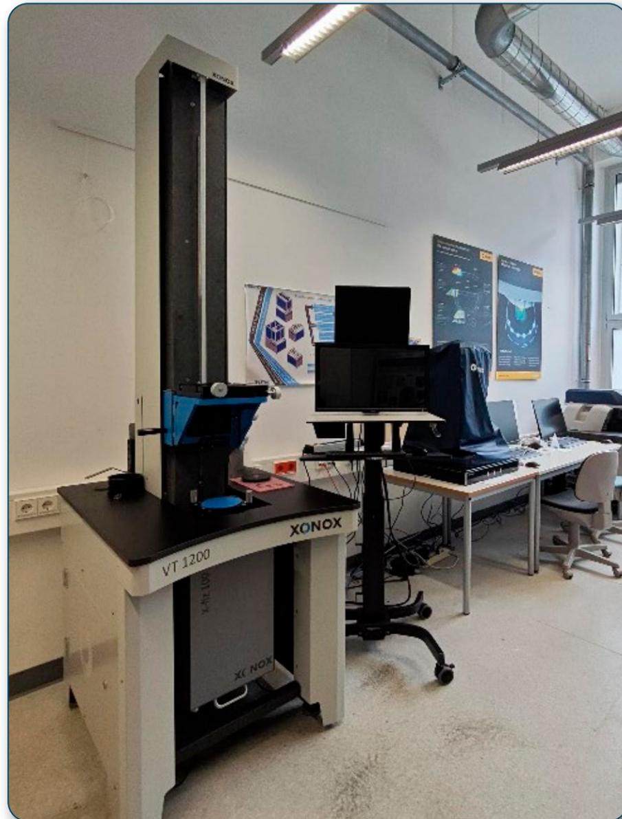
Fizeau-Interferometer VT 1200 der Firma XONOX Technology GmbH in den Laborräumen der AG Bliedtner
